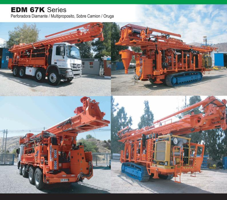
El EDM 67K es un equipo de perforación para trabajo pesado con configuración diamantina o multipropósito, montado sobre camión u orugas.
