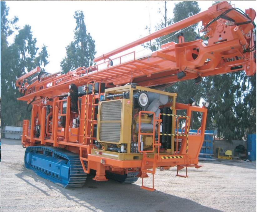
L'EDM 67K est une foreuse à usage intensif, avec des configurations au diamant ou polyvalentes, montée sur camion ou sur chenilles.
