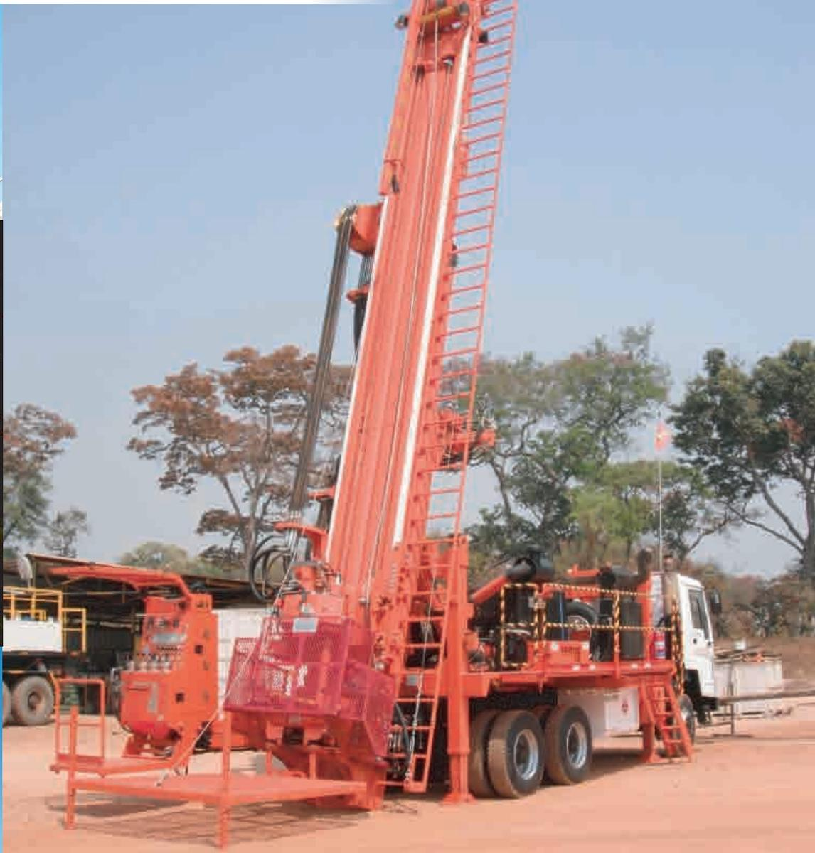
El EDM47K es un equipo de perforación para trabajo pesado con configuración diamantina o multipropósito, montado sobre camión u orugas.
