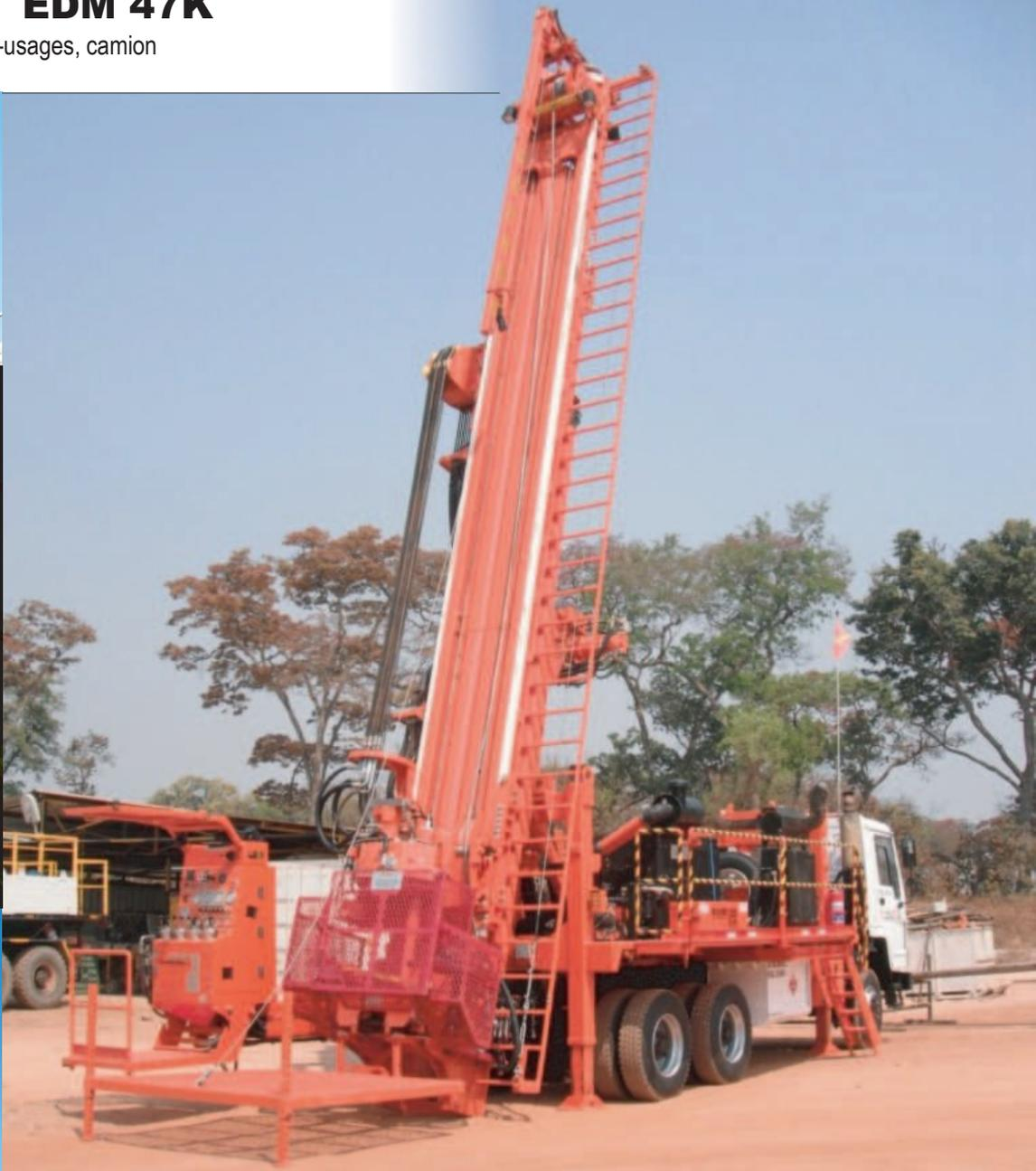
L'EDM47K est une foreuse d'exploration légère et polyvalente avec des configurations au diamant ou polyvalentes.
