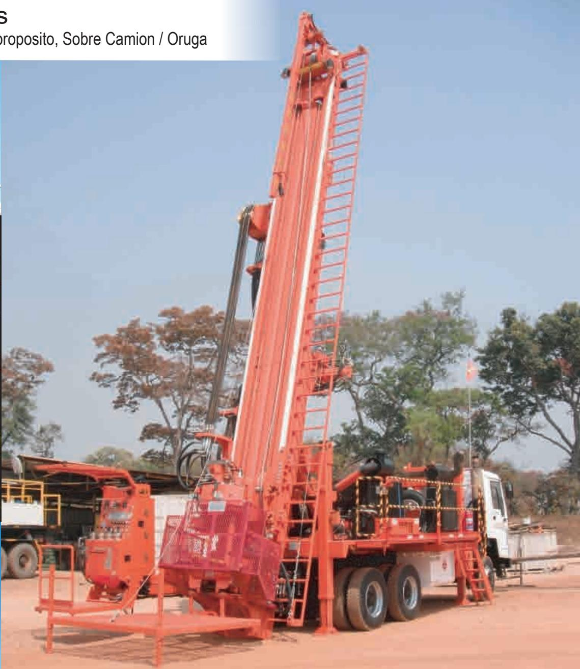
El EDM33K es un equipo de perforación de exploración diamantado liviano y versátil, con configuración diamantina o multipropósito.
