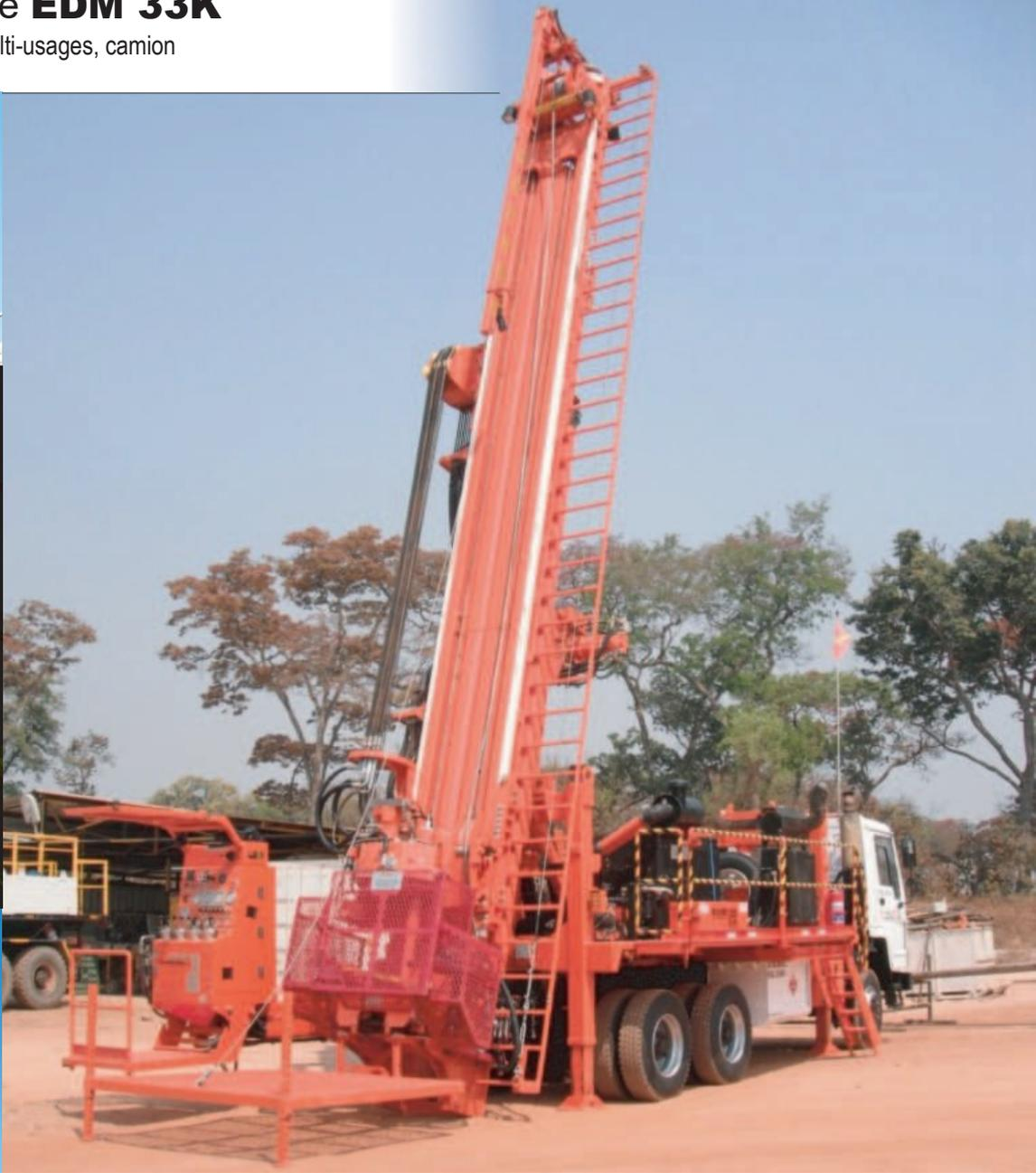
L'EDM33K est une foreuse d'exploration légère et polyvalente, avec des configurations au diamant ou à usages multiples.
